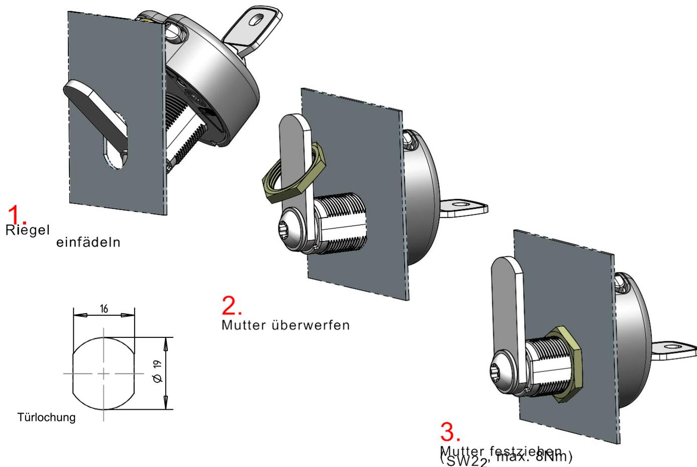
Riegelmontage bei Verwendung eigener Riegel
